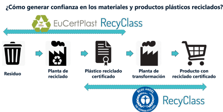
Figura 04: Esquema europeo de trazabilidad con las distintas certificaciones asociadas a los eslabones de la cadena de valor del plástico. Tomado del taller “Caracterización y control de material reciclado” de AIMPLAS (2024)
