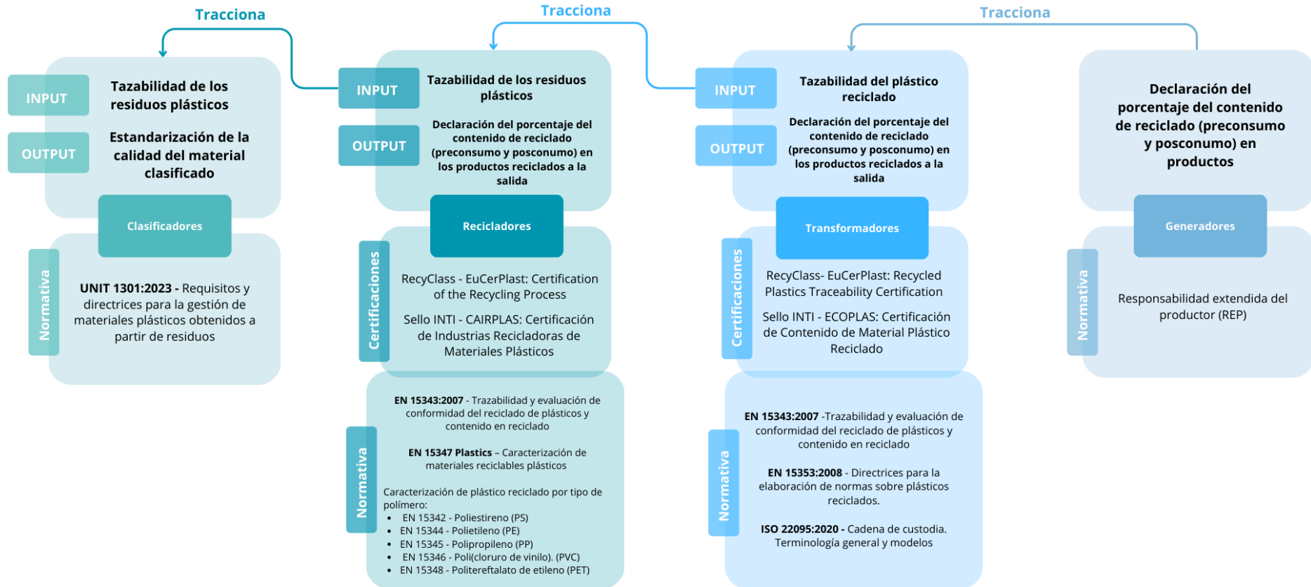
Figura 06: Diagrama con normativas y certificaciones existentes asociadas a cada actor de la cadena de valor del plástico, y el impacto de las regulaciones a lo largo de la cadena. Elaboración propia
